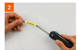
2 Draad in de applicator steken en sleeve over het draad schuiven
