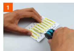
1 Sleeve van de drager afhalen met de SleeveTool applicator
